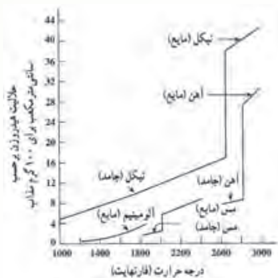
شکل ۱-۲- تأثیر درجه حرارت در حلالیت هیدروژن
