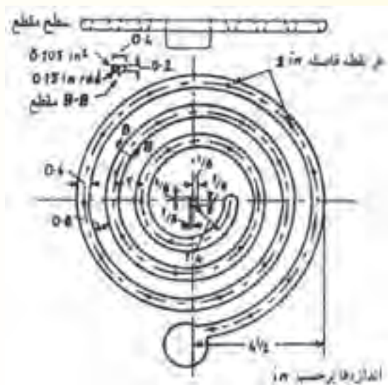
شکل ۱۹-۱- آزمایش مارپیچ برای تعیین سیالیت
