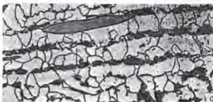
شکل ۸-۲- آخال های سولفیدی در فولاد ۰/۲۵٪ کربن اچ شده در محلول نیتال ۲۰٪ بزرگنمایی ۵۰۰
