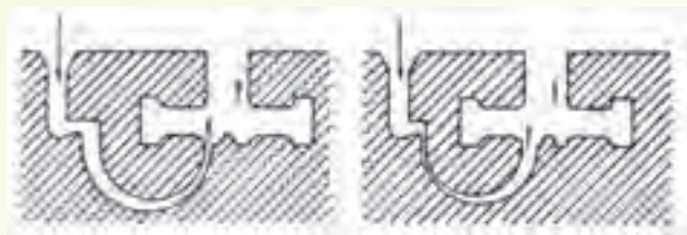
شکل ۱۳-۵- دو نمونه از روش راهگاه‌گذاری از پایین (راهگاه شاخی)
